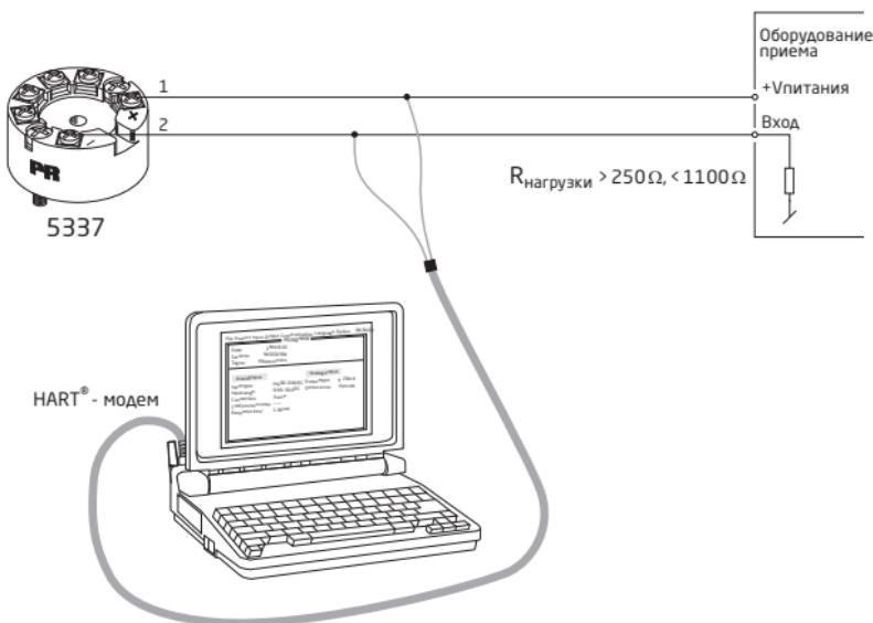
**3:HART®-коммуникатор** О процедуре программирования см. илл. Для получения доступа к специфическим для изделия командам коммуникатор HART® должен иметь DDL-драйвер от PR electronics A/S. Его можно заказать у HART® Communication Foundation или у PR electronics A/S.
