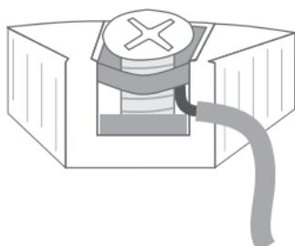
Провод монтируют между пластинами.
