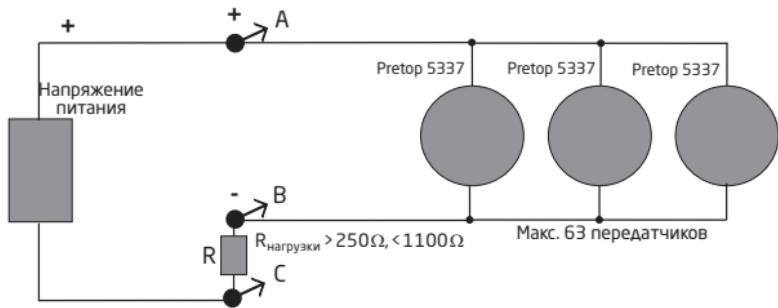
Выходы до 63 модулей можно присоединить параллельно для дискретного обмена данными по протоколу HART®/7 в двухпроводном подключении.
